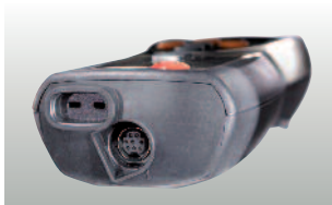
2 разъема для подключения внешних зондов
